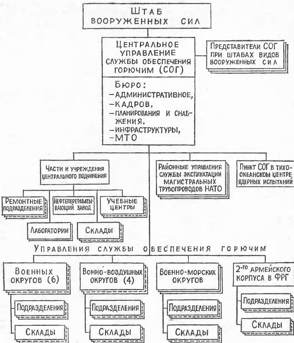
Схема организации службы обеспечения горючим (районные управления службы эксплуатации магистральных трубопроводов НАТО координируют свою работу также с агентством по эксплуатации трубопроводов на Центрально-Европейском ТВД — орган НАТО)
